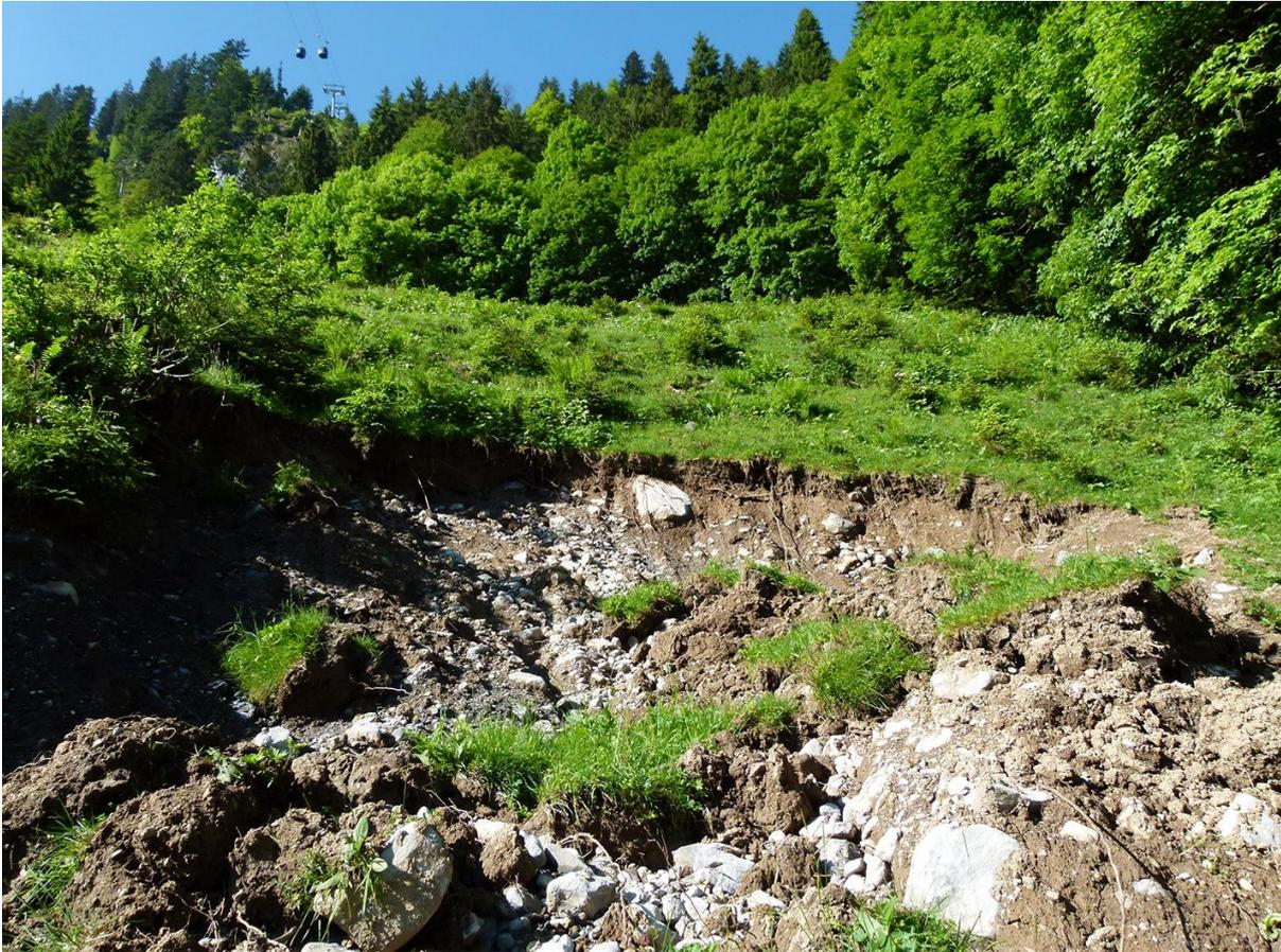
Abbildung 10: Anrissstelle eines Erdrutsches nach einem Starkniederschlagsereignis am 1. Juni 2013. Der Rutsch liegt praktisch in der Falllinie der Hugschwendi-Hangfussquelle (Foto: 16. Juni 2013, M. Trüssel).
